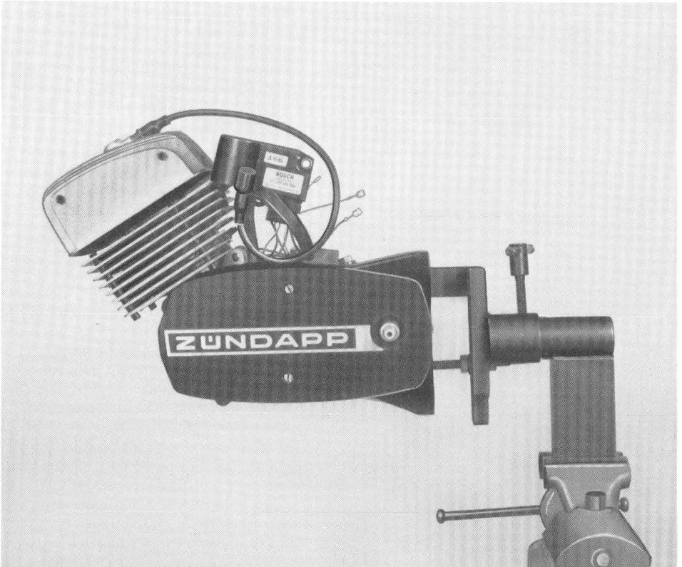
Motor mit Super-Therm-Zylinder in der Haltevorrichtung SK-A 314
